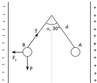
Ao ser abandonado da posição A, o pêndulo oscilará, existindo uma posição de equilíbrio que será determinada por B. Isolando as forças:
