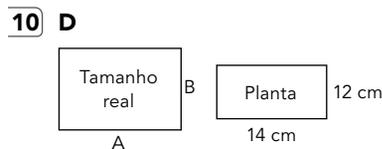
I. Escala =  $\frac{\text{comprimento na planta}}{\text{comprimento real}} = \frac{1}{50}$ .
